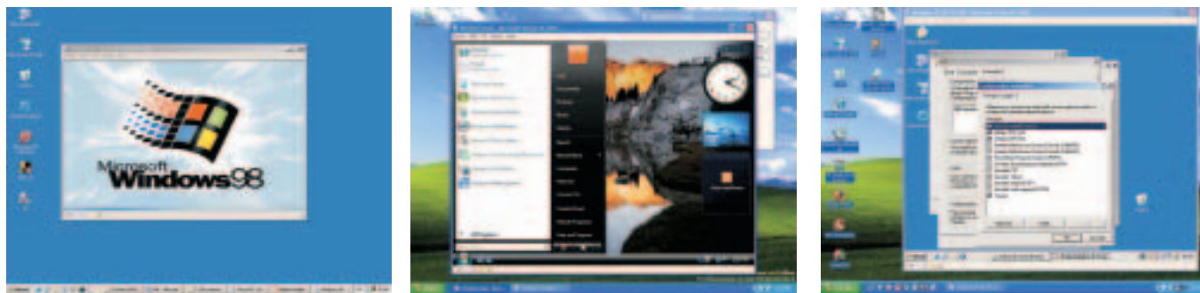
Figura 1 — Exemplos da versatilidade conseguida com o VirtualPC 2007: Windows 98 rodando em uma máquina com Windows 2000 (esquerda), Windows Vista rodando em uma máquina com XP (centro), e uma máquina XP rodando dentro de outra máquina com XP (direita). Com isto, consegue-se vários ambientes de teste dentro da mesma máquina.
